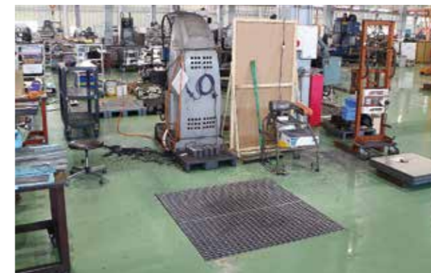
社員のアイデアにより、新工場の床には金属屑を掃き入れる地下収納箱が設けられた
